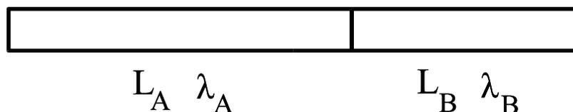
qual è il coefficiente di dilatazione lineare complessivo della sbarra?
